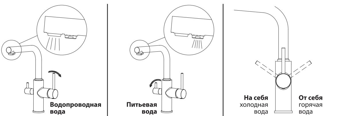
Аэраторы (регуляторы расхода воды) позволяют смесителю «выдавать» ровную водную струю без разбрзгивания.
