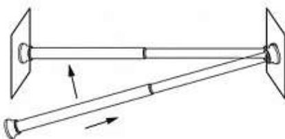
**3** Установите одну сторону карниза на нужном уровне на стене. Аккуратно нажимайте и подталкивайте вторую сторону до соответствующего уровня на противоположной стене.
