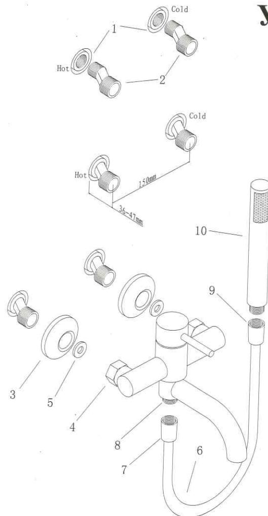
Для установки необходимо иметь поддерживающие фитинги (1) с внутренней резьбой в 1/2". Расстояние между ними 150 мм. Они должны быть вертикальны, трубка на горячую воду должна располагаться слева.
